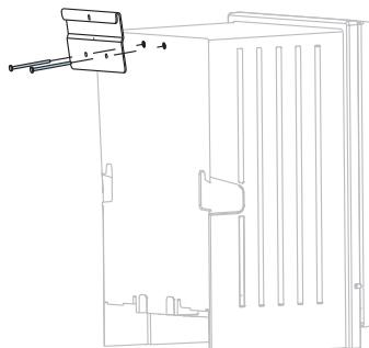
■ 8 Закрепление блока держателя на корпусе
