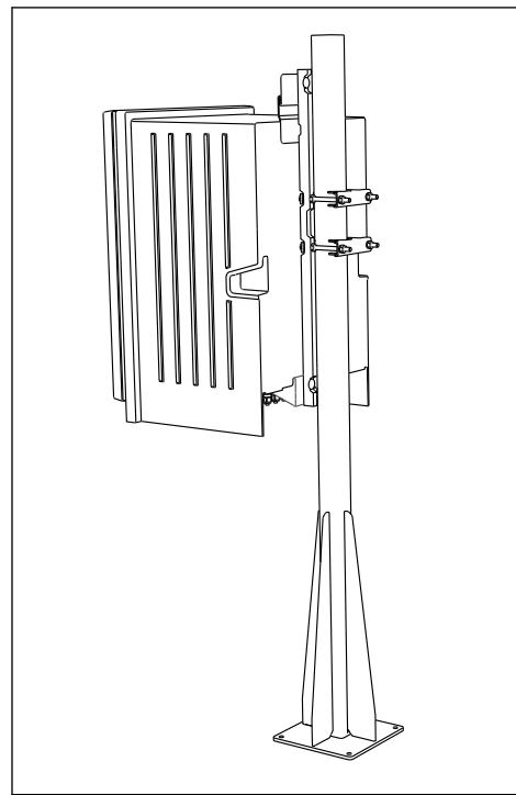
■ 14 Анализатор, смонтированный на стойке (вид сзади)
