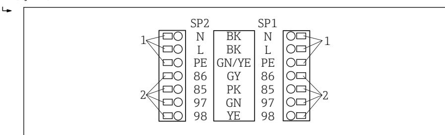
■ 21 Схема подключения для Liquiline System CAT820/860
