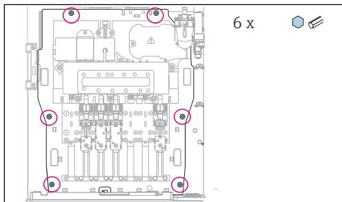
Выверните 6 винтов крепежной панели шестигранным ключом.
