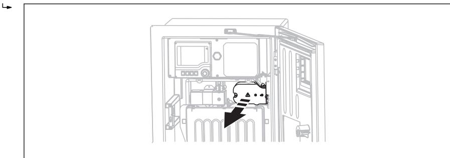
8. Проложите кабель внутри корпуса таким образом, чтобы **оголенный** экран кабеля попадал в один из кабельных зажимов и обеспечивалась простота прокладки жил кабеля вплоть до контактных зажимов.
