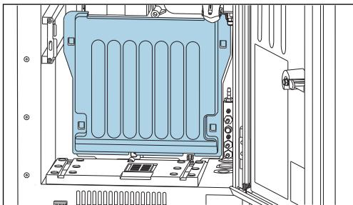
Снимите крышку, закрепленную крючками.
